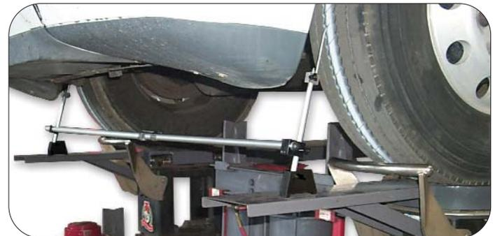
INITIALLY ADJUST THE TELESCOPING TUBES SO THE POINTERS CLOSELY MATCH THE SCRIBE MARKS ON THE FRONT SIDE OF THE TIRES.
